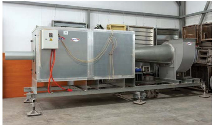
Стенд для определения аэродинамического сопротивления оборудования
