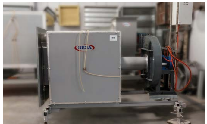
Стенд для определения предельного давления работоспособности клапана
