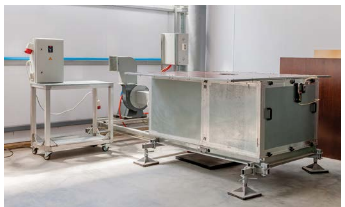
Стенд для определения объема протечки клапана
