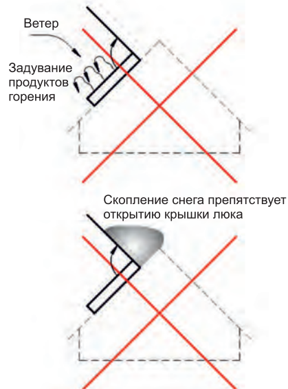
Неправильная схема установки
