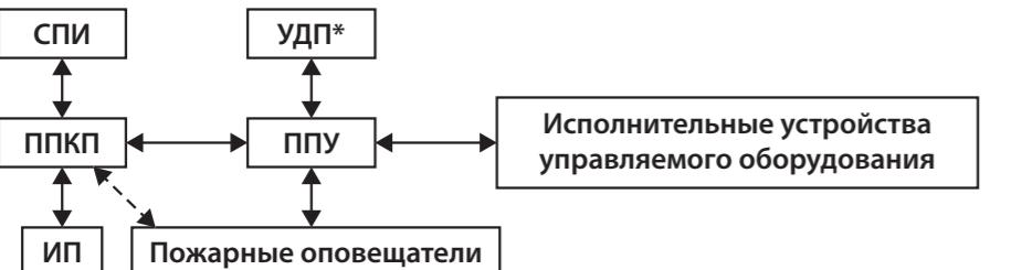
\* Устройство дистанционного пуска-УДП: Компонент блочно-модульного ППУ, предназначенный для ручного запуска систем противопожарной защиты (пожаротушения, дымоудаления, оповещения, внутреннего противопожарного водопровода и т.д.), выполненный в виде конструктивно оформленной кнопки тумблера, переключателя или иного средства коммутации, и обеспечивающий взаимодействие с ППУ по линии связи ГОСТ Р 53325-2012 изм. 2.
